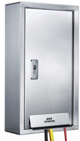
KEMPER 'Tresor' wandopbouwkast figuur 213, H/B/D: 510x285x130 mm, voor het naderhand snel en schoon installeren op een reeds afgewerkte buitenmuur en voor wanden welke niet sterk genoeg zijn voor inbouw
